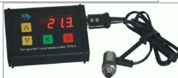
Рис. 2. Ультразвуковой толщиномер ТУЗ-2.
