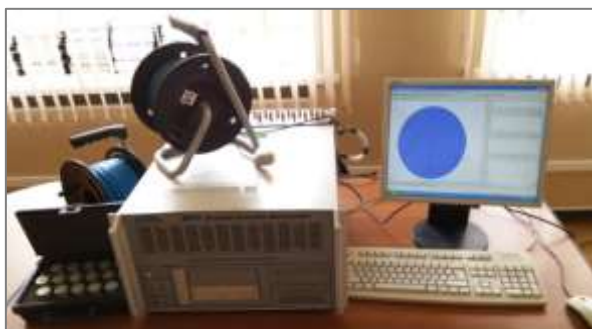
Рис. 7. Прибор для акустико-эмиссионного контроля DISP Acoustic Emission Workstation.
