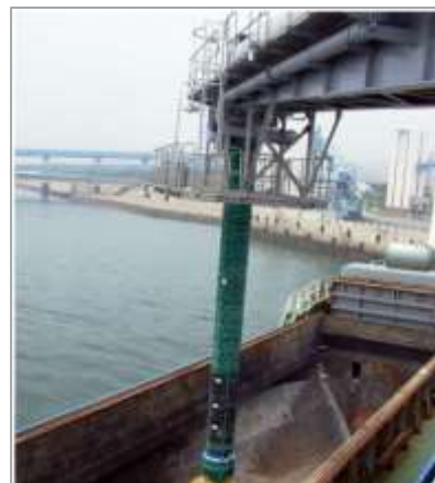
Рис. 5. Предотвращение запыления территории с применением телескопического загрузчика.
