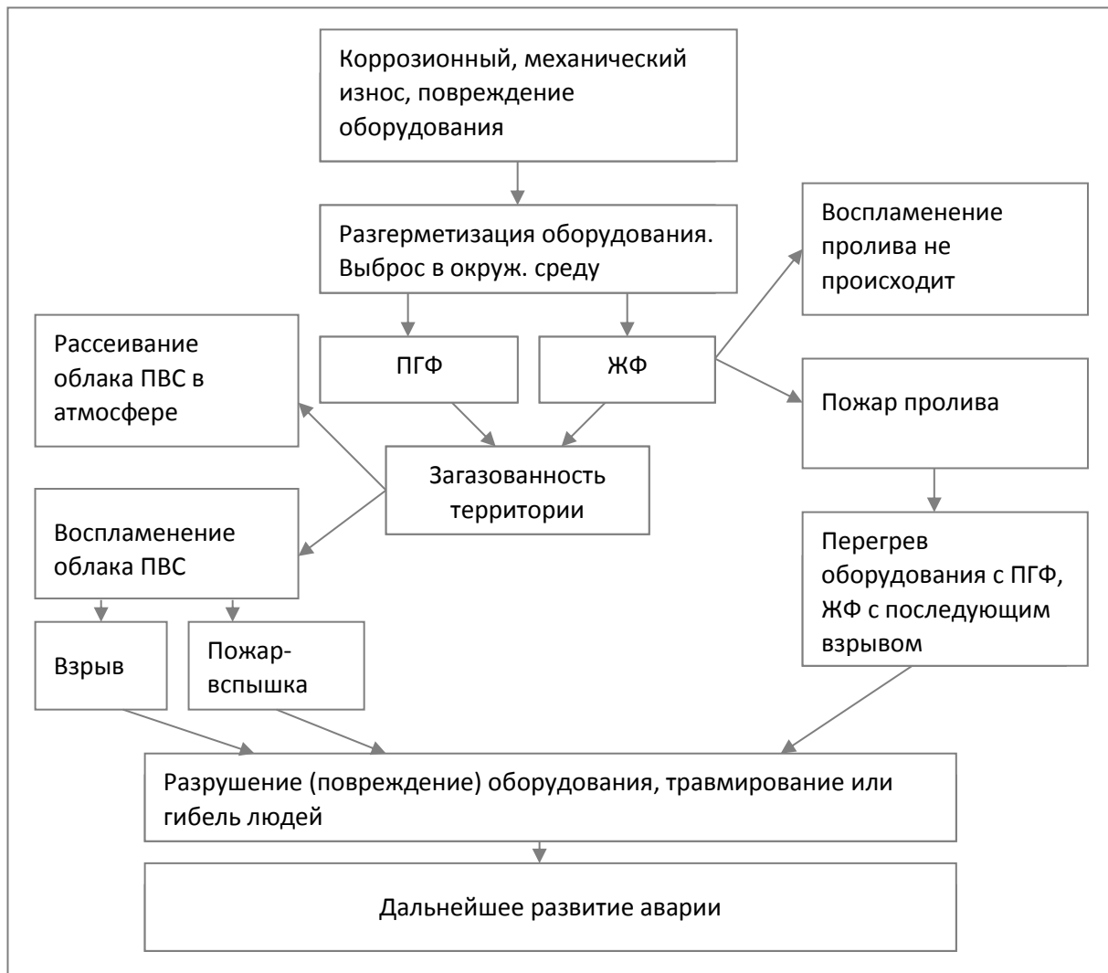
Рис. 1. Сценарий развития аварийной ситуации (ЖФ – жидкая фаза, ПГФ – парогазовая фаза, ПВС – паровоздушная смесь, ПГФ – парогазовая фаза)
