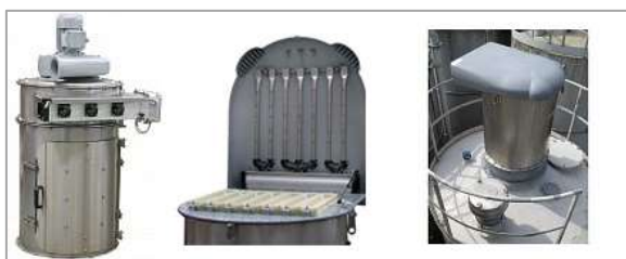
Рис. 3. Силосный фильтр с системой пневмоочистки.
