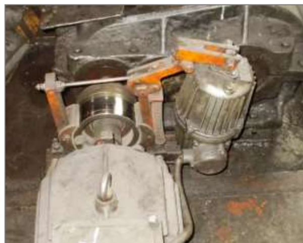
Фото 4. Несоответствие элементов тормоза паспортным данным (гидротолкатель и рычаг).
