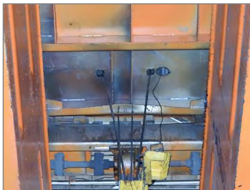
Фото 1-2. Деформация металлоконструкции элементов рамы грузовой тележки.
