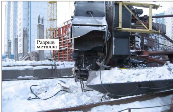
Рис. 6. Сломанный флюгер башенного крана.
