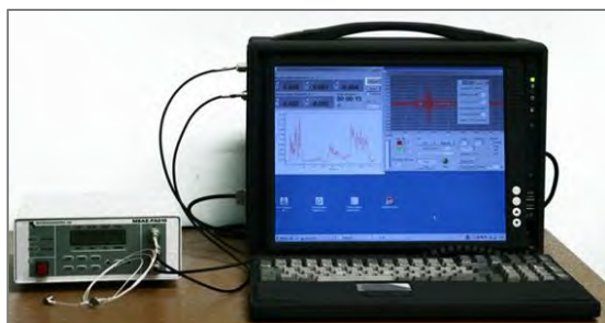
Рис. 3. Установка ЭЯ-2 в развернутом состоянии (моно-блочный компьютер с установленными АЦП и предусилителем MSAE-FA010).
