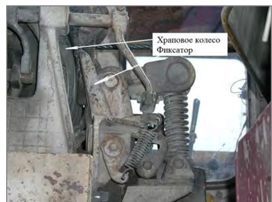
Рис. 2. Храповый механизм крана-трубоукладчика ТО-1224 с выведенным из зацепления фиксатором.
