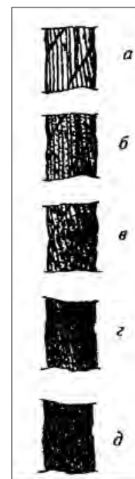
Рис. 18. Поверхностная коррозия проволок каната крестовой свивки: а - начальное окисление поверхности; б - общее окисление поверхности; в - заметное окисление; г - сильное окисление; д - интенсивная коррозия.
