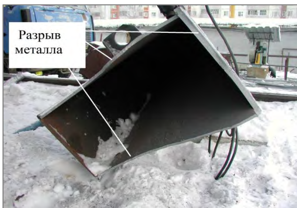
Рис. 7. Сломанный флюгер башенного крана.
