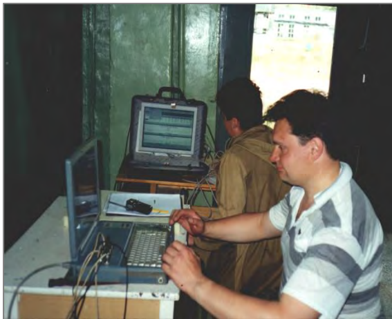
Рис. 7. Проведение акустико-эмиссионного контроля герметичности затвора и корпусных элементов задвижки.
