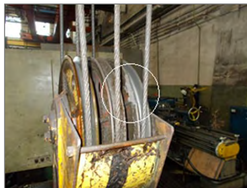
Фото 5-6. Сколы реборд блоков крюковых подвесок.
