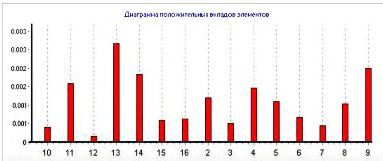
Рис. 2. Диаграмма положительных вкладов элементов энергоблока №1 в его коэффициент готовности. Номера элементов отмечены на оси X.
