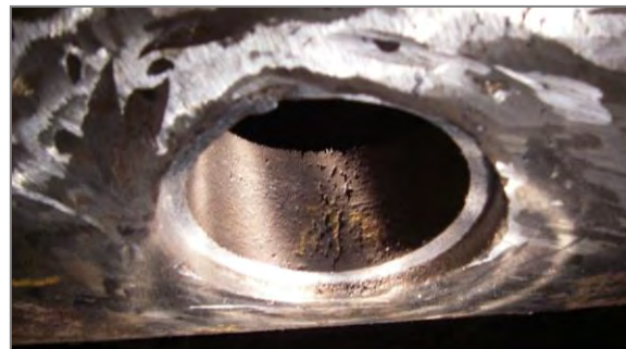
Рис. 1. Внешний вид радиального отверстия с трещинами.
