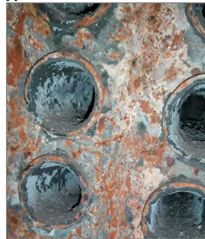
Рис. 2. Отложения на внутренней поверхности после механической обработки.
