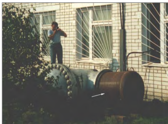
Рис. 5. Внешний вид «наихудшего образца» клиновой задвижки Ду1200 мм и Руб МПа, оснащенной днищами (обозначено стрелкой) для обеспечения герметичности и проведения опрессовки.
