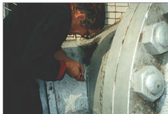
Рис. 6. Подготовка объекта контроля с нанесением искусственного трещиноподобного дефекта-концентратора напряжений.
