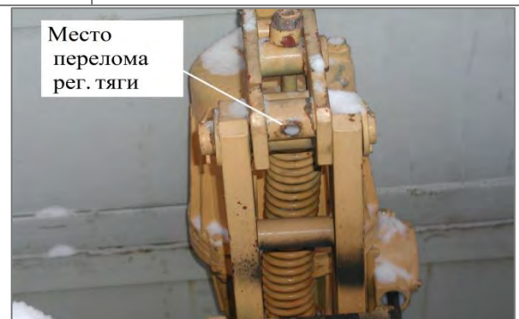
Рис. 2. Место излома регулировочной тяги тормоза стреловой лебедки.
