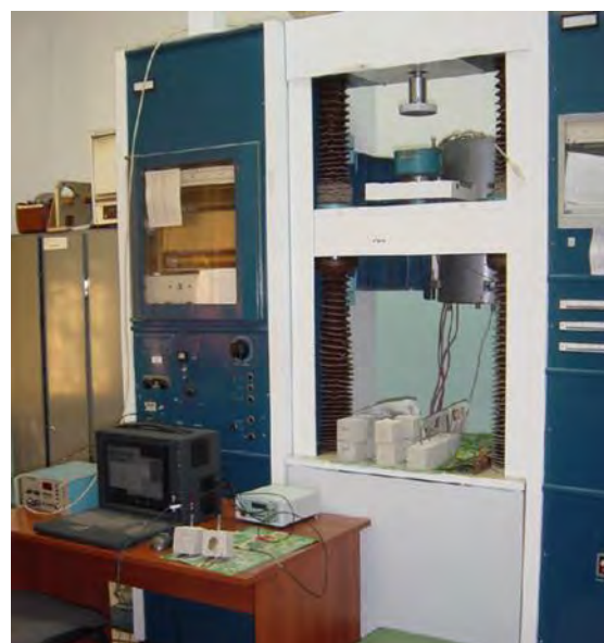
Рис. 2. Испытательная машина для статических испытаний 1231У - 10.
