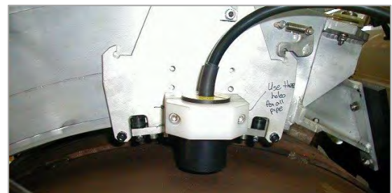
Рис. 1. Устройство для измерения овальности основанное на магнитном методе.
