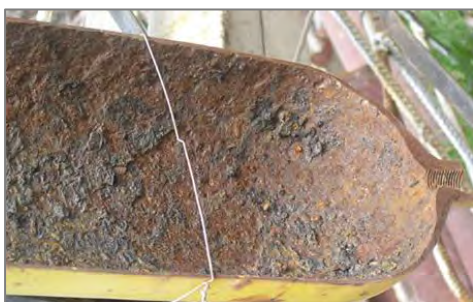
Фото 2. Раковины на внутренней поверхности баллона.
