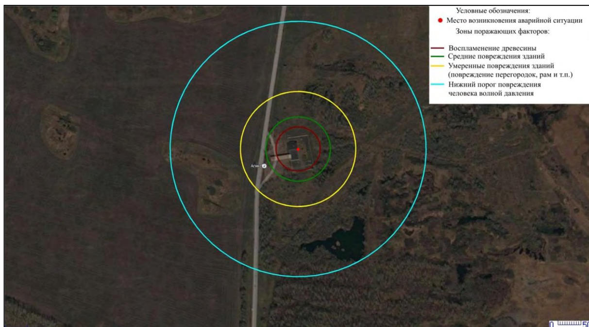
Рис. 4. Схема поражения избыточным давлением построенная по методике определения расчетных величин пожарного риска на производственных объектах.
