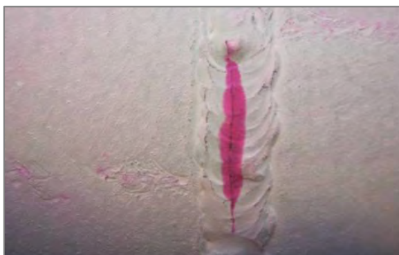
Фото 1. Поверхность, обработанная капиллярной жидкостью. Хорошо видна трещина, которая невооруженным глазом была бы незаметна.
