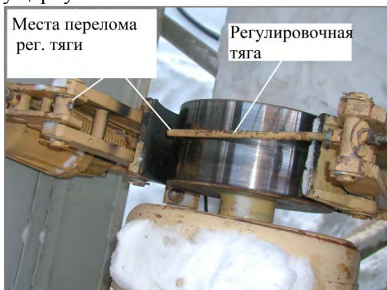
Рис. 1. Место излома регулировочной тяги тормоза стреловой лебедки.
