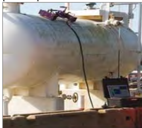
Рис. 1. Проведение коррозионного мониторинга сосуда системой Silverwing RMS2.
