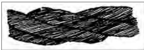
Рис. 13. Обрывы и смещения проволок каната крестовой свивки.
