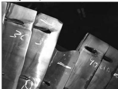
Рис. 9. Коррозионно-усталостные повреждения лопаток, работающих в зоне фазового перехода.
